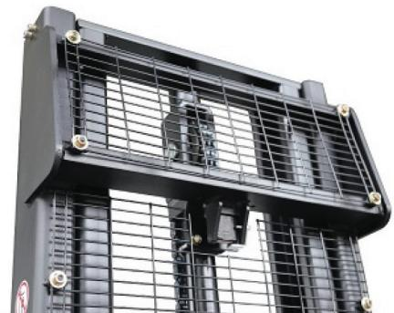
Datorita solutiei de constructie cu un singur cilindru , vizibilitatea este foarte buna, in timpul utilizarii.
